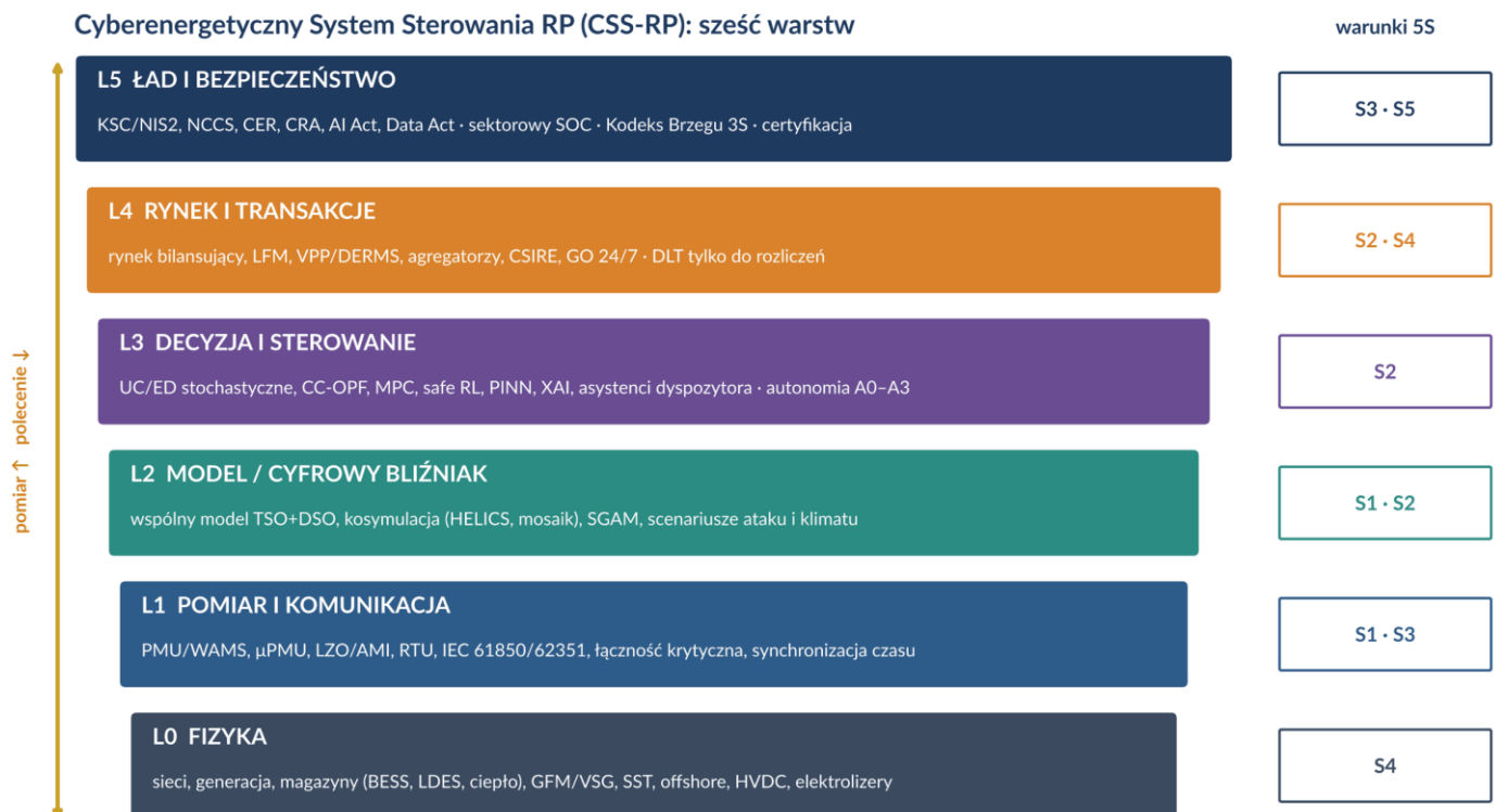
Rysunek 46. Cyberenergetyczny System Sterowania RP (CSS-RP): sześć warstw L0–L5 i przypisane warunki 5S
